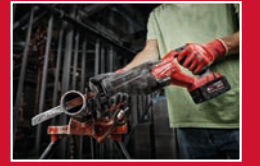
maksimum bıçak kullanımı için ayarlanabilir ön dayama
