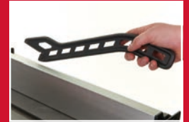
dayama üzerinde itme çubuğu saklama bölmesi
