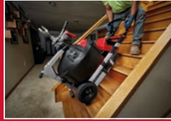
Entegre POWERTREDZ™, hareketli paletler tek kişi rahatlıkla araçtan indirilebilir ve merdivenden çıkartabilir
