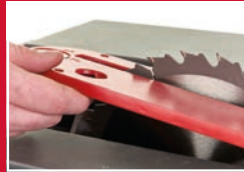
Geri tepme önleyici tınaklar malzemeyi durdurur
