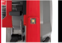
Power ışığı testere sıkışma işlemlerinde kullanıcıyı uyarır
